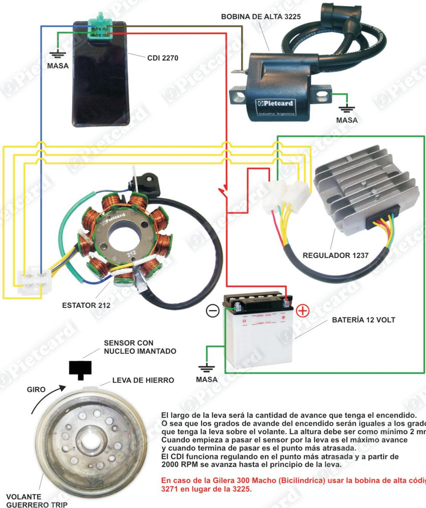
El largo de la leva será la cantidad de avance que tenga el encendido. O sea que los grados de avance del encendido serán iguales a los grados que tenga la leva sobre el volante. La altura debe ser como mínimo 2 mm. Cuando empieza a pasar el sensor por la leva es el máximo avance y cuando termina de pasar es el punto más atrasada. El CDI funciona regulando en el punto más atrasada y a partir de 2000 RPM se avanza hasta el principio de la leva.
